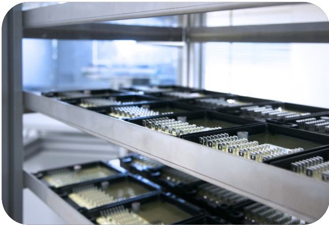
Vakuumverguss unterschiedlicher Steuerungen mit einer Atlas Copco Vakuumzelle ebenfalls am Standort Kressbronn
