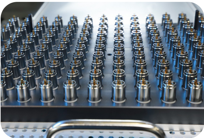
Lohnverguss für medizinische Sensoren von ifm electronic (Tettngang) bei Dipotec
